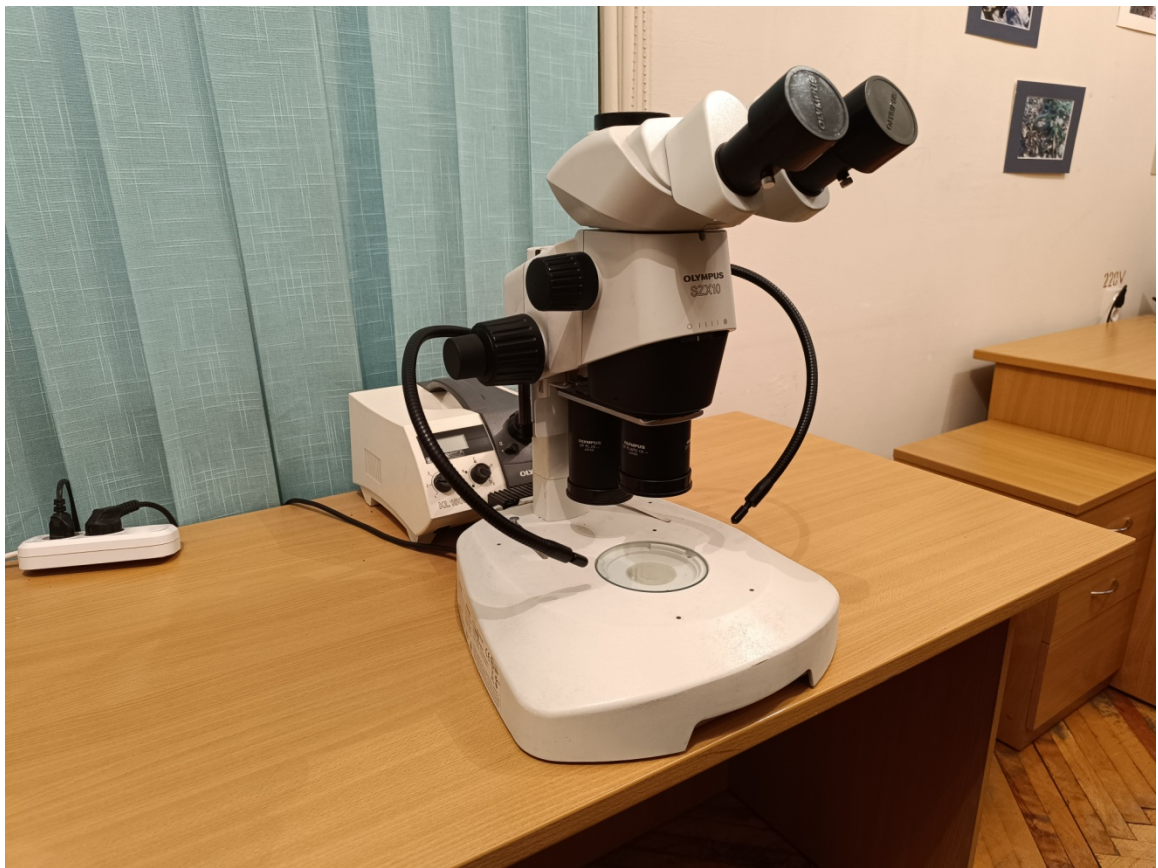
Рис. 9.3. Стереомікроскоп Olympus SZX10 з освітлювачем Schott
